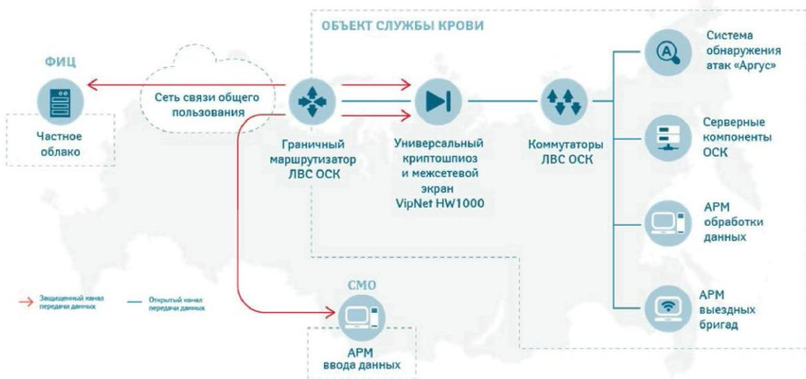
Рисунок 3 - Типовая схема объекта ЕИБД (РИЦ, СПК/ОПК)
